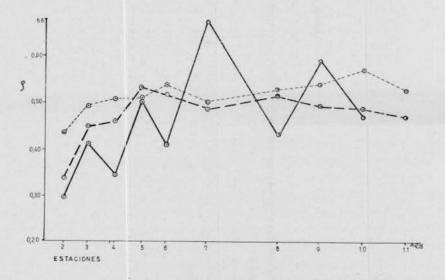
Fig. 20. — Redondez según grados. Línea entera : grado 128-64 mm ; línea cortada: grado 64-32 mm ; línea punteada : grado 32-16 mm
