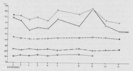
Fig. 5. — Diagrama de variación de mediana y medias. Línea entera: media del grado 128-64 mm; línea cortada: media del grado 64-32 mm; línea rayada y punteada: media del grado 32-16 mm; línea punteada: media del grado 16-8 mm.
