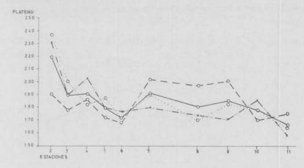
Fig. 15. — Platidad total y por grados. Linea entera: platidad total; linea cortada; grado 128-64 mm; linea punteada: grado 64-32 mm y linea rayada y punteada: grado 32-16 mm.
