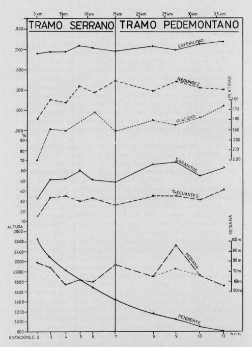
Fig. 23. — Diagrama del conjunto de propiedades sedimentológicas de las gravas y de pendiente del río Sarmiento
