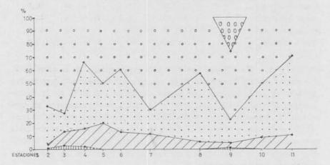
Fig. 4. — Granulometría de las gravas. Ovalos: grado 256-128 n.m; círculos: grado 128-64 mm; puntos: grado 64-32 mm; rayas oblicuas: grado 32-16 mm; rayas verticales: grado 16-8 mm.
