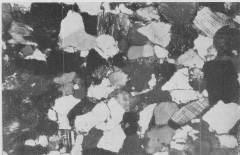
Fig. 13. — Contactos cóncavo convexos, complicados con crecimiento secundario y corrosión
