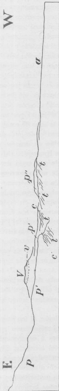
Fig. 3. — Corte transversal de la base de la ladera izquierda del valle Calchaquí, 500 metros al Norte del volcán septentrional; capas proterozoicas cabalgando por cobijadura sobre areniscas del terciario: V, Volcán; v, Materiales sueltos en la cima del volcán septentrional; a, Acarreo de falda y de escombros volcánicos; p, Ladera constituida por las capas proterozoicas; p', Escalón de la base de la ladera constituida por capas proterozoicas; p'', Capas proterozoicas desmenuzadas sobre las areniscas terciarias; t, Cobijadura.
