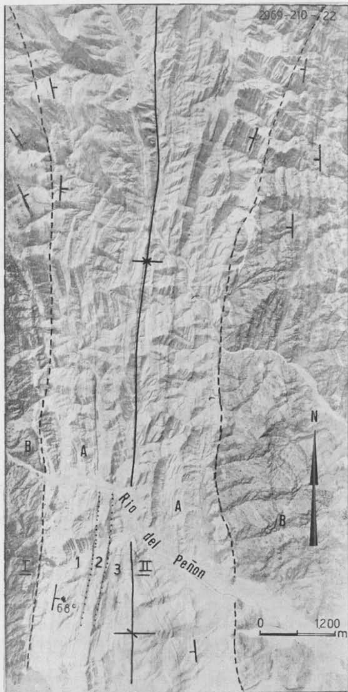
Fig 4. — Plano geológico sobre foto aérea de la zona del río del Peñon. A. Formación Quebrada Larga (Carbónico superior); B. Andesita cerro El Chusco y Formación Panilla ? (Devónico). Miembros de la Formación Quebrada Larga: 1. Areniscas blancuecinas; 2. Areniscas y lutitas marinas; 3. Areniscas y lutitas gris verdosas. I-II. Traza del perfil. En el sector norte del mapa es bien claro el cambio de rumbo entre el Carbónico y el Devónico por existir entre ellos una discordancia angular.
