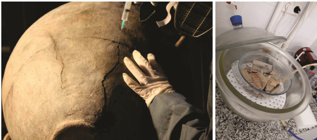
Figura 3. Aplicación de consolidante mediante inyección en una grieta e inmersión. Por Ana Igarreta.
