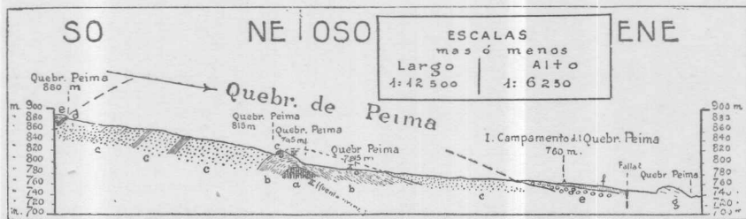
Fig. 8. — Perfil de la Quebrada de Peima (Caiza). Reducido á más ó menos 1 : 25.000 (largura) y 1 : 12.500 (altura). Para la explicación de las letras véase pl. II (fig. 7)
